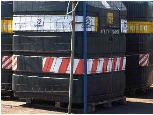
Contenedores para el almacenamiento en instalaciones portuarias de aceites usados y residuos oleosos
